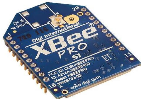
Fig. 5. Xbee Pro module.
